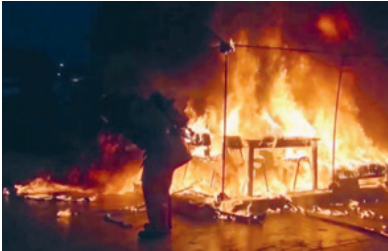
Anche se classificate ufficialmente come ignifughe, le casette Better Shelter di Ikea in un test sono bruciate in 90 risp. 30 secondi.
